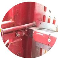
Monitoramento do sinal do dispositivo de detecção de sobrecarga
